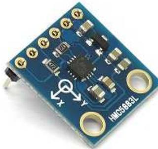
Figure 17 : magnétomètre boussole [2]
