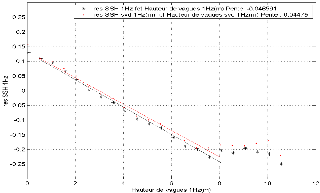
Figure 5-3 Résidu 1Hz en fonction de la hauteur de vagues 1 Hz. En astérisques noires ( \alpha \approx -4,66\% de \text{SWH} ). En points rouge avec la SVD ( \alpha_{\text{SVD}} \approx -4,48\% de \text{SWH}_{\text{SVD}} ) (99 demi orbites du cycle 61 de JASON)
