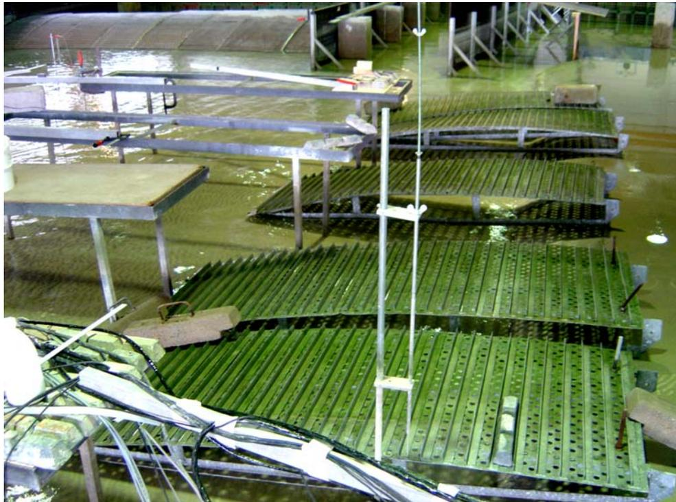
Figura 4.3 Sistema de absorción pasiva utilizada en los ensayos.
