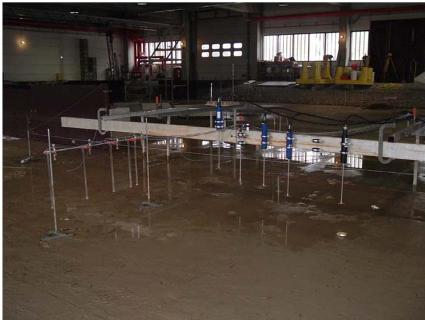
Figura 4.5 Fotografía oblicua de la cuenca somera, disposición de los sensores de presión y de los velocímetros.
