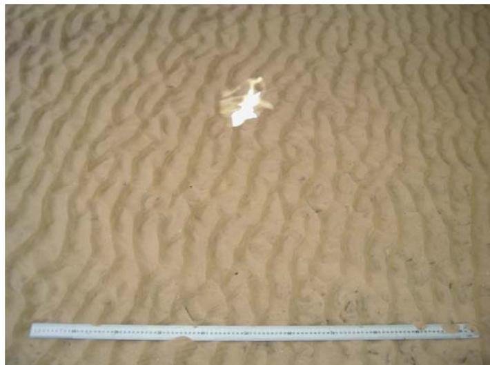
Figura 4.16 Formas de lecho generadas en el ensayo 04H1RW2N.
