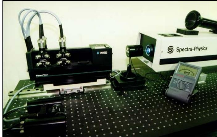
Figure 2.13. : Système laser avec mesureur de puissance
