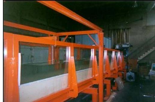
Figure 2.1.b. : Canal à houle et/ou courant
