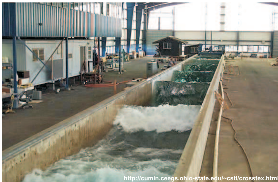
FIG. 7.3 – Canal à houle de large dimension du O.H. Hinsdale Wave Research Laboratory de l'université d'état d'Oregon.
