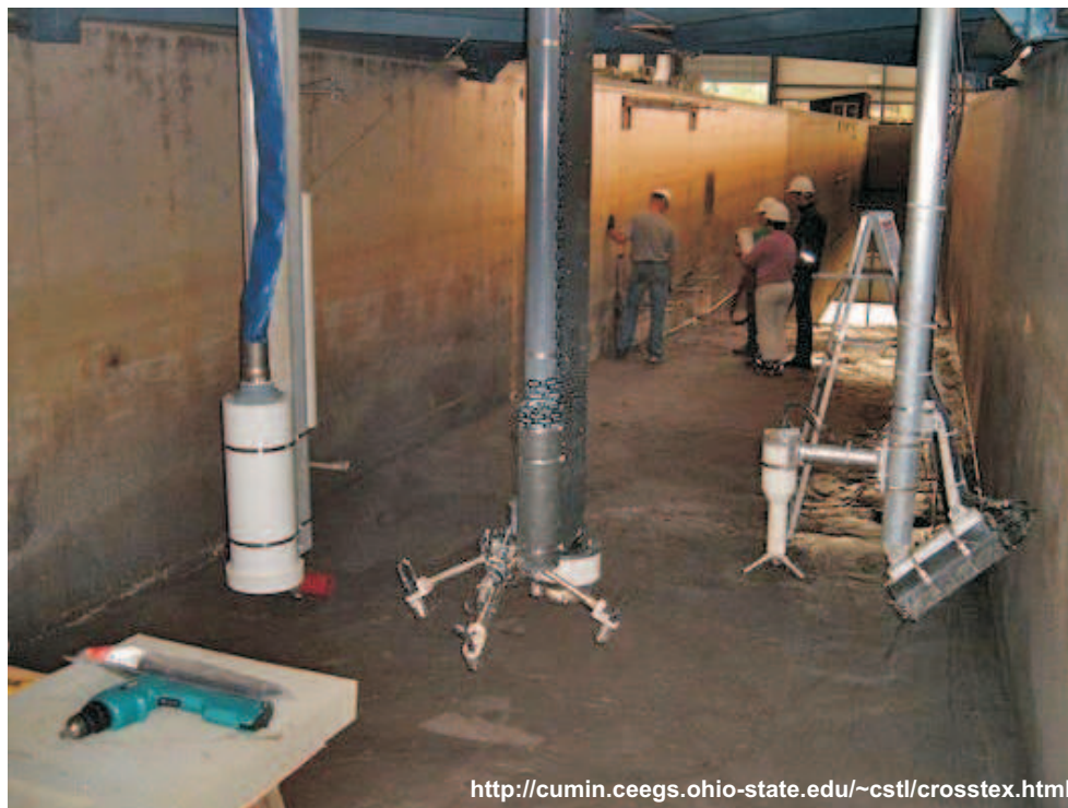
FIG. 7.4 – Dispositif de mesure dans le canal à houle ; de gauche à droite : Sonar (Imagenex) et PIV laser (Dantec), vélocimètre cohérent bi-statique, puis ADV (Sontek) et vidéo.
