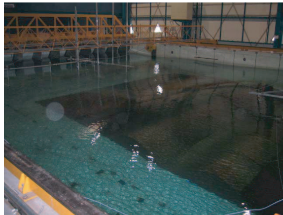
FIG. 6.23 – Bassin à houle
