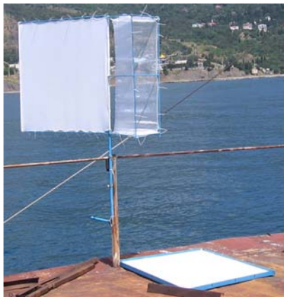
Р и с . 2 . Пастки для атмосферного аерозолю горизонтального та вертикального потоків.
