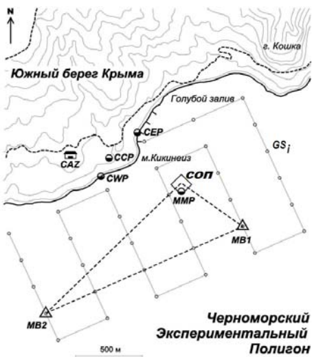
Р и с . 1 . Схема Черноморского экспериментального полигона с технической сетью морской наблюдательной системы и стационарной океанографической платформой (COIP).
