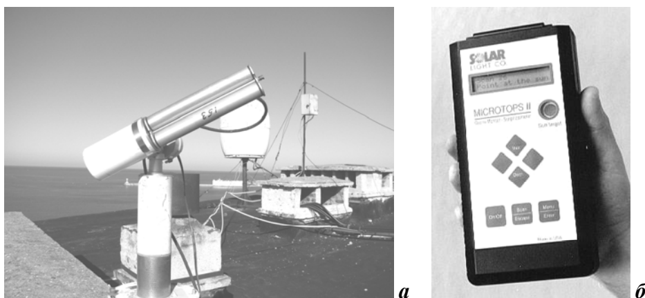
Рис. 5. Солнечные спектрофотометры для измерений оптических характеристик атмосферного аэрозоля над Черным морем: фотометр CIMEL-318 (стационарно установлен на здании МГИ в Севастополе) (а); переносной спектрофотометр MICROTOPS II (использовался для измерений с океанографической платформы и экспедиционных судов) (б).
