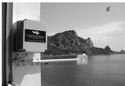
Р и с . 2 . Общий вид подводного модуля (а), антенны GPS и датчика атмосферного давления (б).
