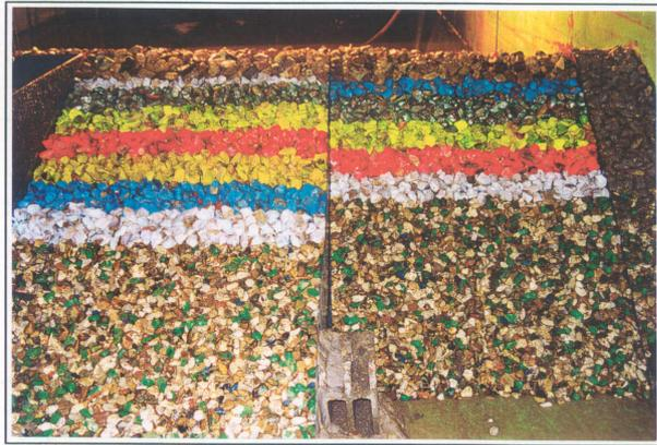
Figure 30 : Vue de l'arrière de la digue sur une moitié du canal à houle (une taille de bloc, mais deux pentes différentes)
