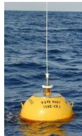
**Figure 7 : Bouée directionnelle DATAWELL WAVERIDER**
