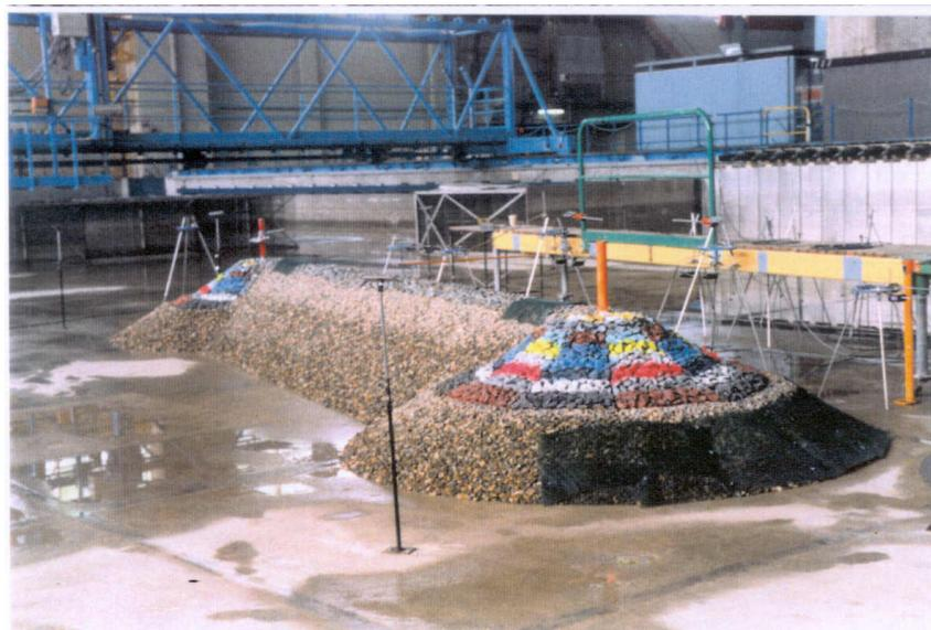
Figure 34 : Vue du modèle en cuve à houle multidirectionnelle utilisé pour les essais du projet européen MAST2-RMBFM
