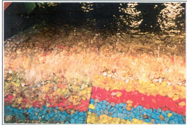
Figure 31 : Franchissements en cours d'essai, entraînant des dommages sur le talus arrière.)
