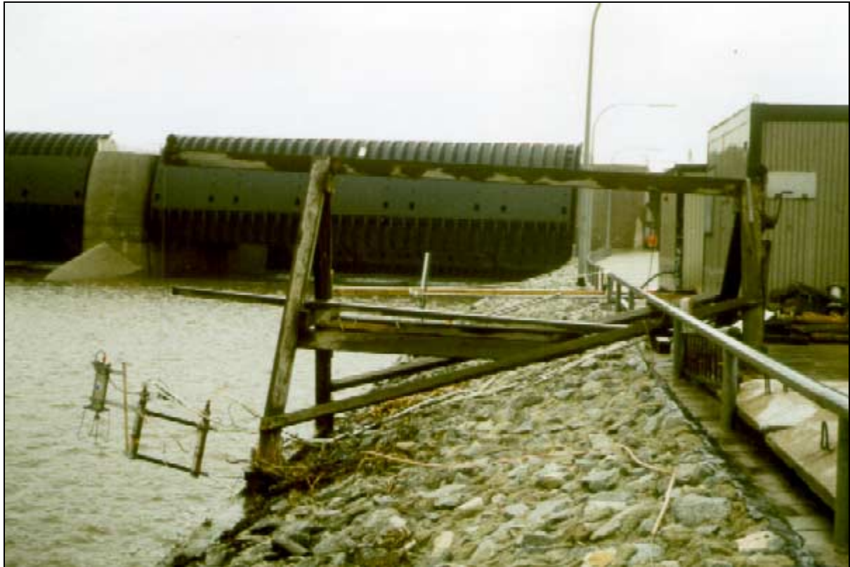
Abbildung 22: Anordnung der Probeentnahme und des Strömungssensors
