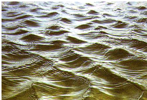
FIG. 5.3 – Photo d'un champ de vagues typique du stade 4 pour un vent de 6m/s au fetch 9m. Même prise de vue que pour la figure 5.1.
