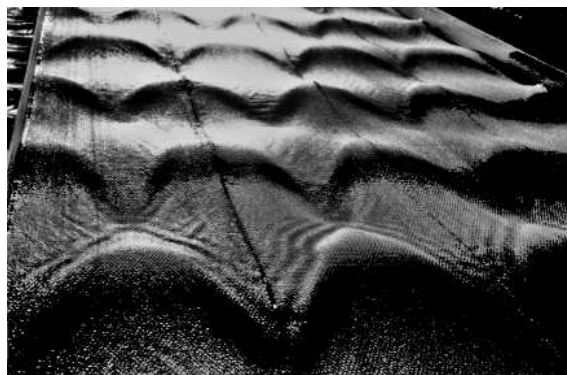
FIG. 3.19 – Instabilité d'une onde initiale à la fréquence 1.4Hz formant des "fers à cheval" à la fois alignés (crêtes 2-3) et en damier (crêtes 1-2 3-4 4-5).
