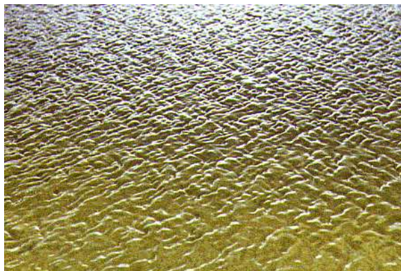
FIG. 5.1 – Photo d'un champ de vagues typique du stade 2 pour un vent de 6m/s au fetch 2m. Le vent souffle de droite à gauche et l'angle de prise de vue est incliné de 30 ° sous l'horizontale.
