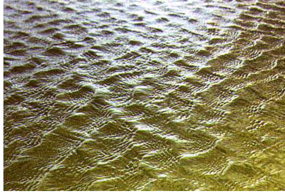
FIG. 5.2 – Photo d'un champ de vagues typique du stade 3 pour un vent de 6m/s au fetch 4m. Même prise de vue que pour la figure 5.1.
