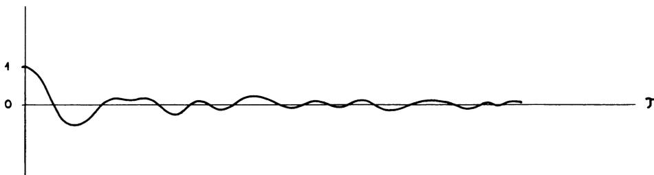
Figure 4 - Courbe d'autocorrélation d'un enregistrement de houle naturelle.
