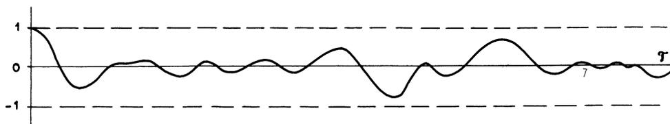
Figure 5 - Courbe d'autocorrélation d'une oligo-houle.
